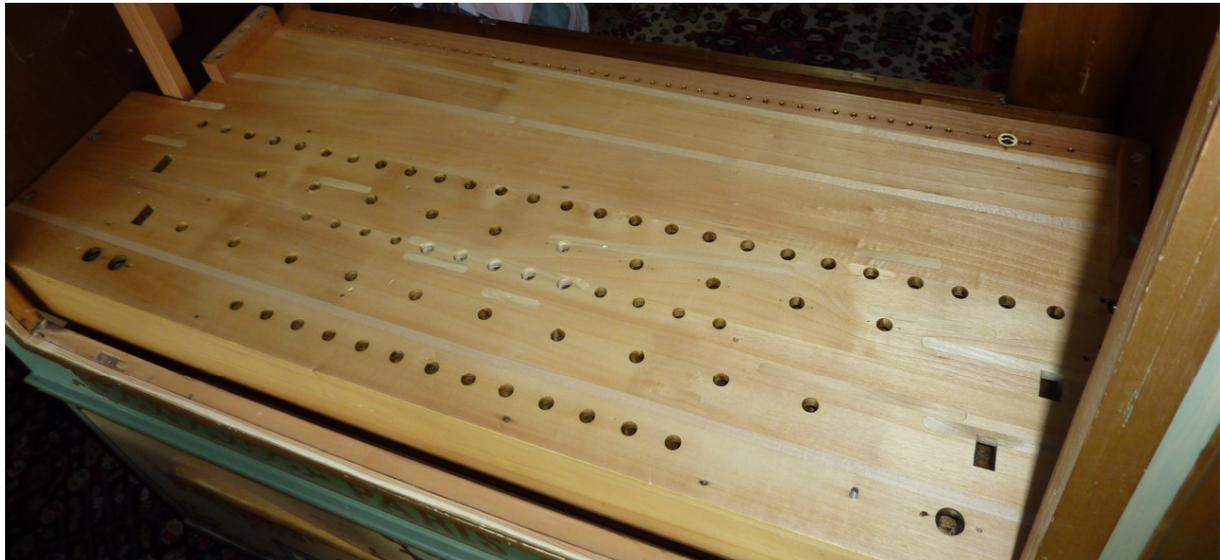
Bei der Windlade mussten diverse Trocknungsrisse ausgespant werden
