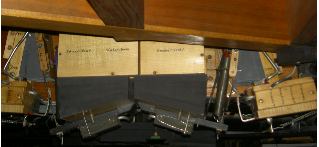
Die komplizierte Betonungseinrichtung unter dem Flügel
