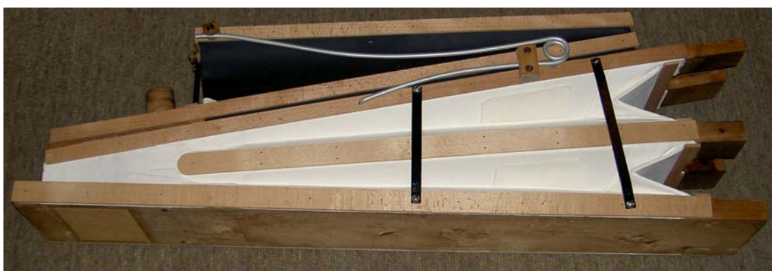
Der neu belederte Vakuumbalg.
